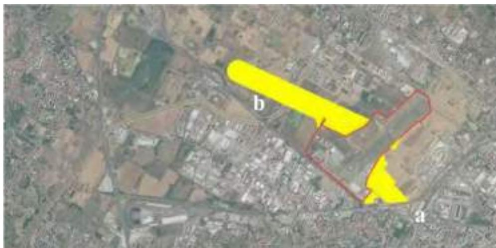
Figura 5.3 – Sedime aeroportuale. Identificazione delle aree in ampliamento rispetto allo stato attuale
